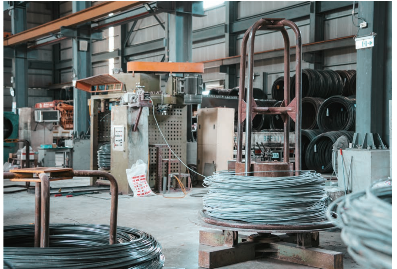
金屬材料經抽線處理，能提升的強度、硬度和耐磨性，製成螺絲的品質佳。
