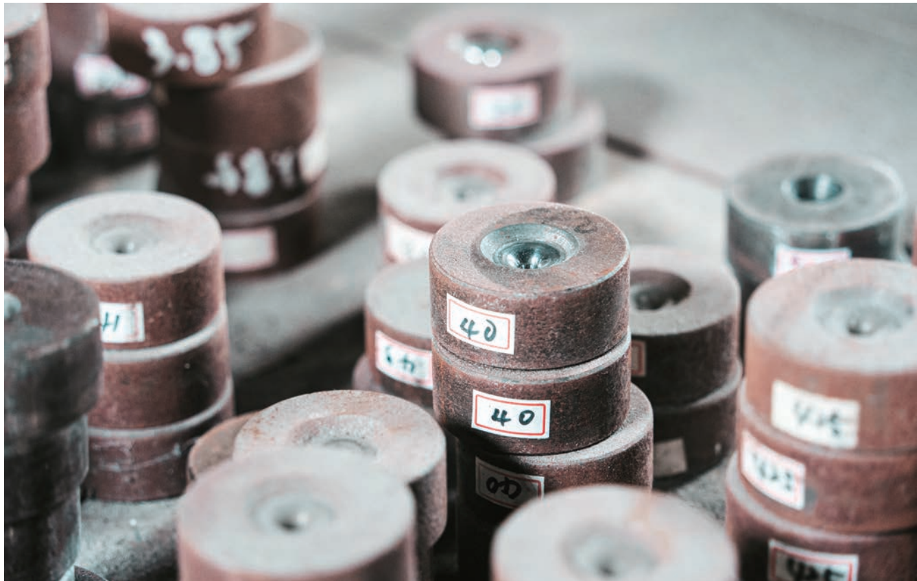
從中鋼採購被稱為「盤元」的鋼鐵原料，透過模孔拉伸使線徑縮小。
